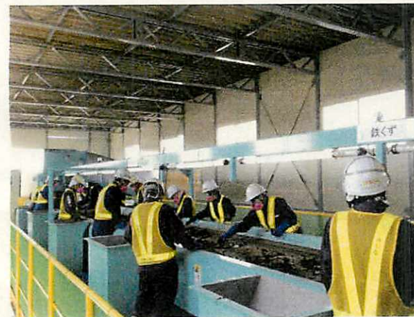
人力二次選別(ピッキングライン)
